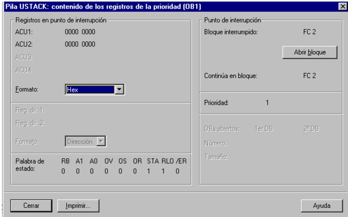
En la parte izquierda de la ficha nos da información del estado del PLC cuando se fue a STOP. Además tenemos un botón que dice “Abrir bloque”. Si pinchamos en este botón se abrirá el bloque que contenía el error y nos señalará con el ratón la instrucción que contiene el error.
