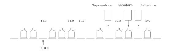
Vemos que en la línea tenemos tres máquinas. Una taponadora, una lacadora y una selladora.
