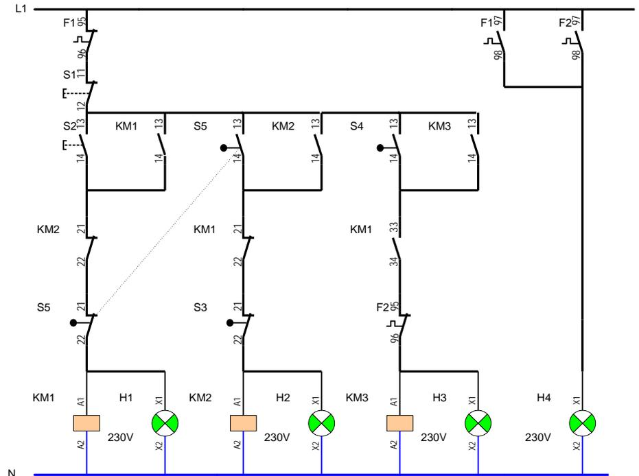
Al pulsar la marcha el sistema se pondrá en funcionamiento hacia la derecha, al llegar a la mitad del recorrido (S4) se activa la electroválvula (EV1) que vierte material en la caja, al llegar al final (S5) la electroválvula se desactiva y el sistema retorna a la posición de inicio donde parara a la espera de un nuevo ciclo.
