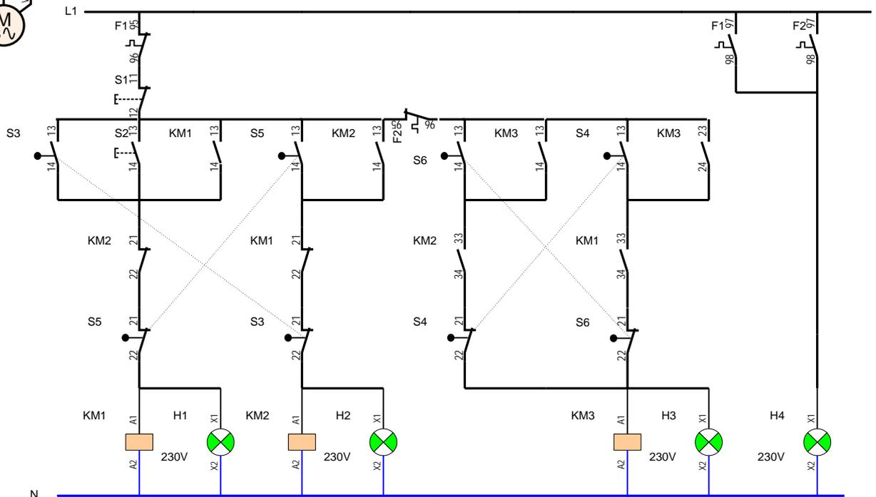
Al pulsar la marcha el sistema se pondrá en funcionamiento hacia la derecha, al llegar a S4 se activa la electroválvula EV1 que vierte material en la caja, al llegar a S6 la electroválvula se desactiva y el sistema continua avanzando hasta S5 retorna hacia la posición de inicio, de forma que al volver a pasar por S6 se vuelve activar la electroválvula y seguirá activada hasta llegar a S4, a partir de ese punto el sistema continua hasta S3 donde comenzará un nuevo ciclo.
