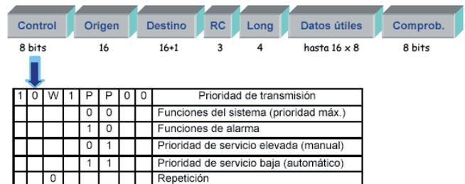
El telegrama que se transmite por el bus, y que contiene la información específica sobre el evento que se ha producido, tiene siete campos, seis de control para conseguir una transmisión fiable y un campo de datos útiles con el comando a ejecutar). En la Figura A26 se muestra el formato de la trama y el tamaño de cada uno de estos campos:
