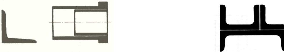
4. Si la superficie a rayar fuera excesivamente grande, puede quedar limitado el rayado a una zona del borde que indica el contorno de la superficie cortada.
