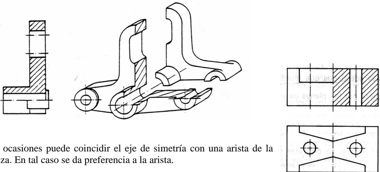
En ocasiones puede coincidir el eje de simetría con una arista de la pieza. En tal caso se da preferencia a la arista.
