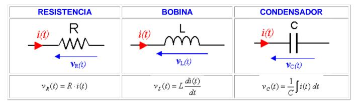
La variación de tensión en la resistencia es proporcional a la intensidad, mientras que en la bobina y en el condensador lo es a su derivada y a su integral respectivamente.
