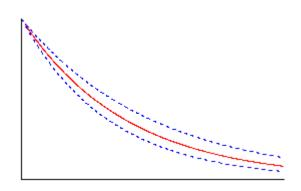
Sistema críticamente amortigüado
