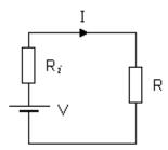
Si podemos escoger la resistencia de carga, para distintos valores de R circula una intensidad diferente que produce distintas potencias útil y perdida.
