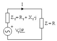
Si tenemos un circuito equivalente de Thévenin alimentando una resistencia pura (parte imaginaria de la carga nula). La potencia activa disipada en la red pasiva será el producto de la resistencia por el cuadrado de la intensidad que circula por ella:
