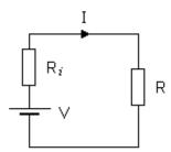
Si tenemos un generador de corriente continua alimentando una resistencia de carga R, la potencia activa disipada en dicha resistencia de carga será el producto de la resistencia por el cuadrado de la intensidad que circula por ella:
