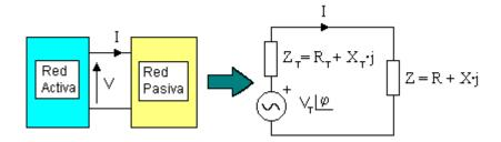
Si tenemos una red pasiva alimentada por una red activa, podemos sustituir la primera por una impedancia equivalente y la segunda por su circuito equivalente de Thévenin. La potencia activa disipada en la red pasiva será el producto de la resistencia por el cuadrado de la intensidad que circula por ella:
