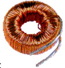
En el caso de un anillo de Rowland, la longitud **L** sería la longitud media del núcleo del solenoide y la inducción sería la misma en cualquier punto del solenoide.
