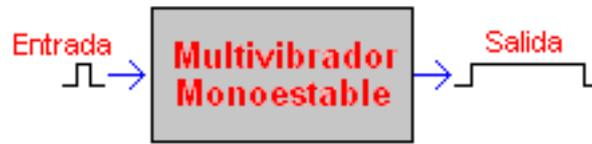
*Figura 11: Multivibrador monoestable*
