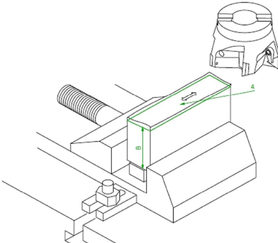
5.- Colocar la pieza en posición vertical. Para asegurar la perpendicularidad con la 4ª superficie mecanizada anteriormente nos ayudaremos de una escuadra. En el caso de necesitar posicionar la pieza con mayor precisión, podríamos posicionar la pieza utilizando un reloj comparador.
