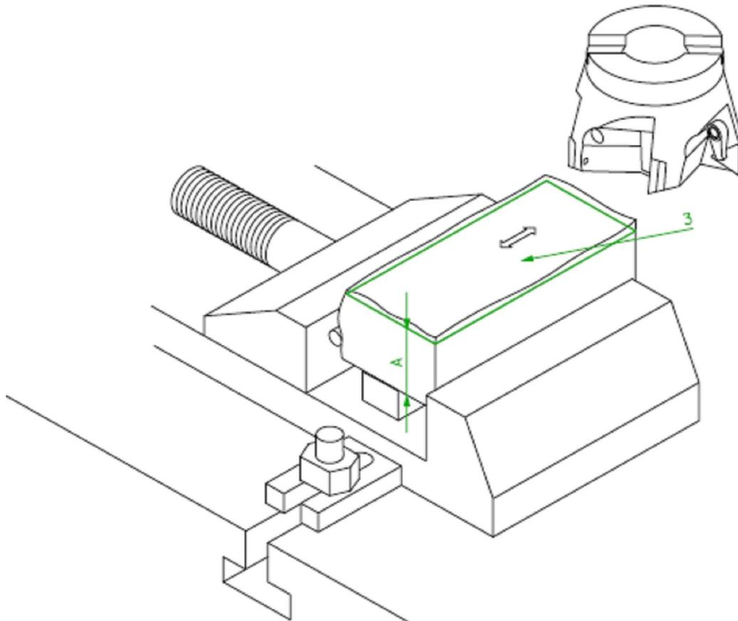
4.- Girar la pieza 90° colocando la última superficie mecanizada (sup.3) contra la mordaza fija. En esta ocasión no hace falta poner el rodillo ya que la 1ª y 3ª superficies mecanizadas son paralelas entre sí.
