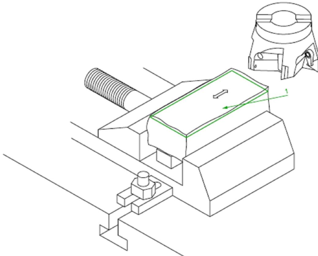
2.- Girar 90° la pieza y colocar la superficie mecanizada contra la mordaza fija y realizar el apriete utilizando un rodillo contra la mordaza móvil para asegurar la perpendicularidad de la 1ª superficie y la 2ª que se va a mecanizar.
