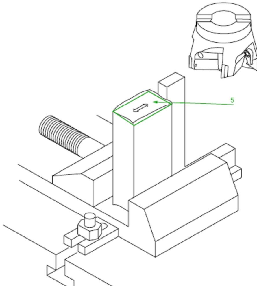
6.- Girar la pieza de tal forma que coloquemos la última superficie mecanizada (sup.5) encima de una superficie fija de la mordaza, y en varias pasadas de desbaste mecanizar hasta conseguir una longitud deseada.
