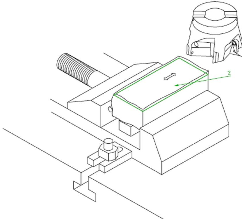
3.- Girar la pieza 90° y colocar la superficie mecanizada (sup.2) contra la mordaza fija y realizar el apriete utilizando un rodillo contra la mordaza móvil, para así asegurar la perpendicularidad de la 2ª superficie con respecto a la 3ª que se va a mecanizar (sup.3). Tomar referencia y realizar varias pasadas en desbaste hasta conseguir  $A+0.5$  (45.5 ó 35.5 mm) entre la 1ª superficie y la que se esta mecanizando (sup.3).
