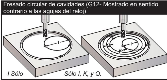
Estos códigos G asumen el uso de la compensación de la herramienta de corte, por tanto no se requiere un G41 o G42 en la línea de programa. Sin embargo, se requiere un número de corrector D, para el radio o diámetro de la herramienta de corte, para ajustar el diámetro del círculo.
