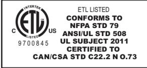
Todas las herramientas de la máquina CNC llevan la marca ETL, certificando que están conformes con el Estándar eléctrico NFPA 79 para maquinaria industrial y el equivalente canadiense, CAN/CSA C22.2 No. 73. Las marcas ETL y cETL se adjudican a productos que han sido probados satisfactoriamente por Intertek Testing Services (ITS), una alternativa a los Laboratorios Aseguradores.
