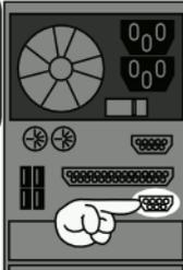
LAS TARJETAS QUE VIENEN INCLUIDAS EN LOS MAINBOARDS SOLO TIENEN ESE CONECTOR. MIENTRAS QUE LAS MAS AVANZADAS PUEDEN TENER CONECTORES HASTA PARA PODER USAR UNA ANTENA DE TELEVISION Y VER LA SEÑAL A TRAVES DE LA COMPUTADORA.
