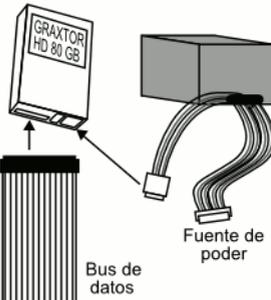
EL BUS DE DATOS VA CONECTADO EN UN EXTREMO AL DISCO DURO Y EN OTRO A UNO DE LOS CONECTORES IDE EN EL MAINBOARD. SUELE HABER DOS CONECTORES IDE EN CADA MAINBOARD.
