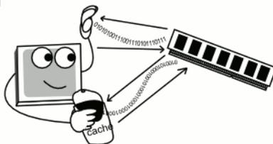
COMO EL PROCESADOR RECOGE LOS DATOS QUE TIENE QUE PROCESAR DE LA MEMORIA RAM, EL CACHE SE COLOCA EN MEDIO Y ALLI SE QUEDAN LOS QUE SON USADOS CON MAS FRECUENCIA. DE ESA MANERA, EN LUGAR DE TENER QUE RECURRIR SIEMPRE A LA RAM, EL PROCESADOR USA EL CACHE. ASI, LA COMPUTADORA SE HACE MAS VELOZ.
