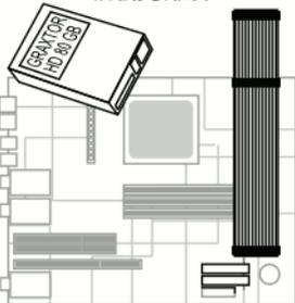
CADA BUS DE DATOS TIENE TRES CONECTORES: UNO ES PARA EL IDE Y LOS OTROS SON PARA UNIDADES DE DISCO. ESTO SIGNIFICA QUE EN UN MAINBOARD CON DOS CONECTORES IDE PODEMOS TENER HASTA CUATRO DISCOS DUROS.
