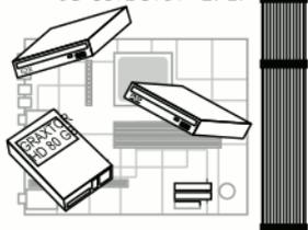
EN UNA COMPUTADORA COMUN, CON LOS DOS CONECTORES IDE Y TENIENDO UN DISCO DURO Y UNA UNIDAD DE CD, AUN PODRIAMOS CONECTAR UNA UNIDAD DE DVD Y OTRO DISCO DURO.
