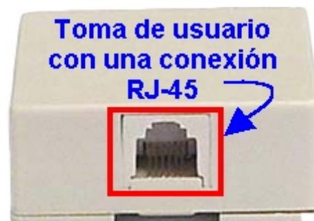
En el mercado encontrarás muchos modelos, colores y accesorios orientados a la instalación de estos conectores, ya sea en cajas de superficie, empotrables, o para colocar en canaletas especialmente diseñadas.
