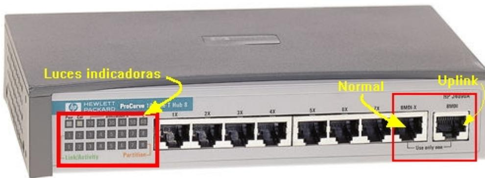
Recuerda siempre que cuando conectes un ordenador, el puerto ha de estar en modo normal. Si conectas, por ejemplo, otro hub o un switch, el puerto ha de estar en modo uplink. De no hacerlo así, el equipo conectado no sería reconocido en la red.
