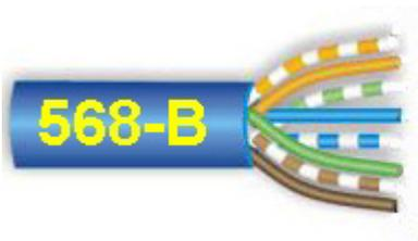
8. Finalmente comprueba la continuidad del cable, bien con un comprobador de cables de red o con un polímetro. Ten presente el cruce de los pines en este tipo de cable a la hora de las comprobaciones.
