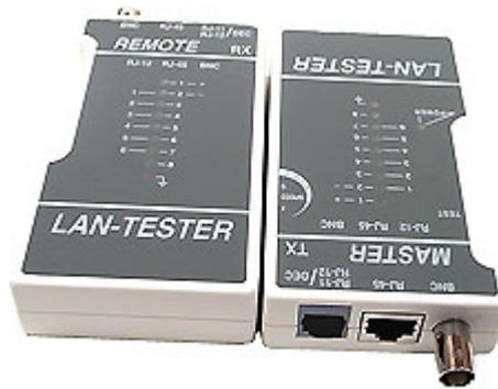
Pero nosotros no podemos ir tan lejos, bastará con disponer de un **comprobador de cables** o en su defecto, de un **polímetro**, para comprobar:
