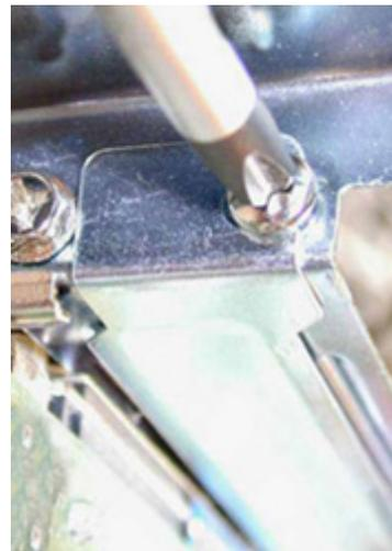
4. **Inserta la tarjeta de red en un slot PCI libre.** En un principio, procura respetar el orden de inserción no dejando ranuras PCI intermedias. Presta atención a que la tarjeta quede bien conexonada y sus contactos entren perfectamente en el conector PCI.
