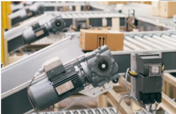
*El arrancador de motor dentro la red AS-Interface lo hace posible: Los motores se pueden proteger y arrancar directamente en campo.*
