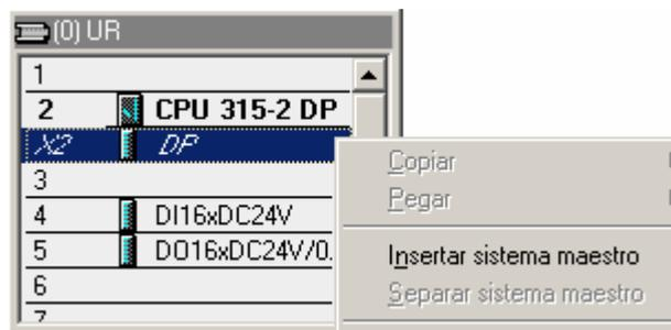
Del sistema maestro DP deberá colgar la CPU Esclavo. Para ello vamos al Catalogo de Hardware → Carpeta “PROFIBUS DP” → Carpeta “Estaciones ya configuradas” → Y aquí seleccionamos la CPU correspondiente.
