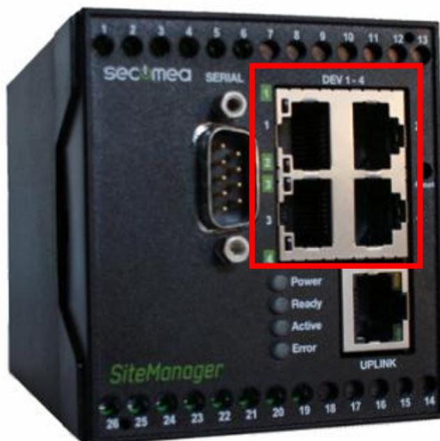
El puerto DEV1, viene configurado por defecto con la dirección IP 10.0.0.1 Esta dirección se puede cambiar de igual modo que configuramos el resto de los puertos (DEV2-4).
