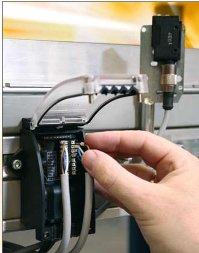
▲ Es suficiente con encajar a presión el cable de E/S. Después, cierre la tapa y ya está.
