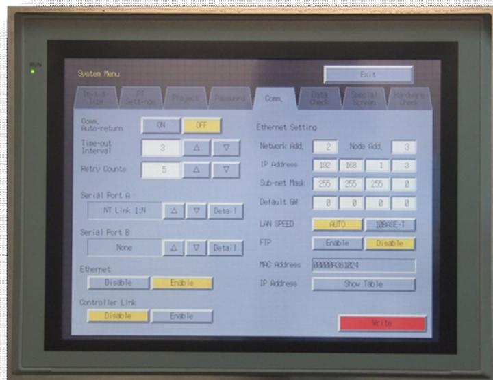
3 Para poder enlazar la NS con el PC y poder transferir la configuración, es necesario ir al menú "PT" – "Transferir" – "Configuración de transferencia". Se abre la ventana "Método de comunicaciones" que permite realizar dicha configuración.
