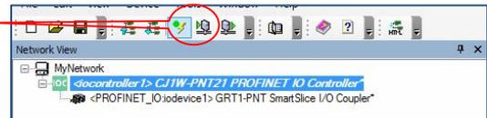
c. Realizada la transferencia, es posible comprobar el correcto funcionamiento de la misma, seleccionando la unidad maestra, en diagnosis, se puede ver el estado de la red. En la figura se ha realizado el refresco de forma manual, también es posible hacerlo de forma automática. Proceder igual para ver el estado de los esclavos desde la ventana IO Device Status.
