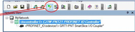
b. La transferencia se realiza desde el icono "Down Load Parameter" y con el PLC en Stop.
