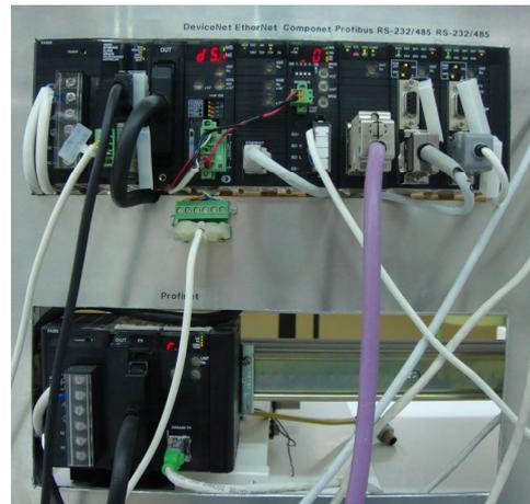
Además de todos los componentes reseñados los cuales conforman el entrenador en sí, se utilizan 2 PLCs CJ2M con CPU 31 dotados de unidades esclavas DeviceNet y Profibús, y que además pueden intercambiar información entre sí a través de su puerto Ethernet-IP
