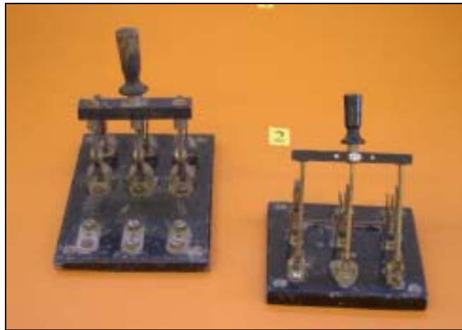
Antiguos interruptores de cuchillas
