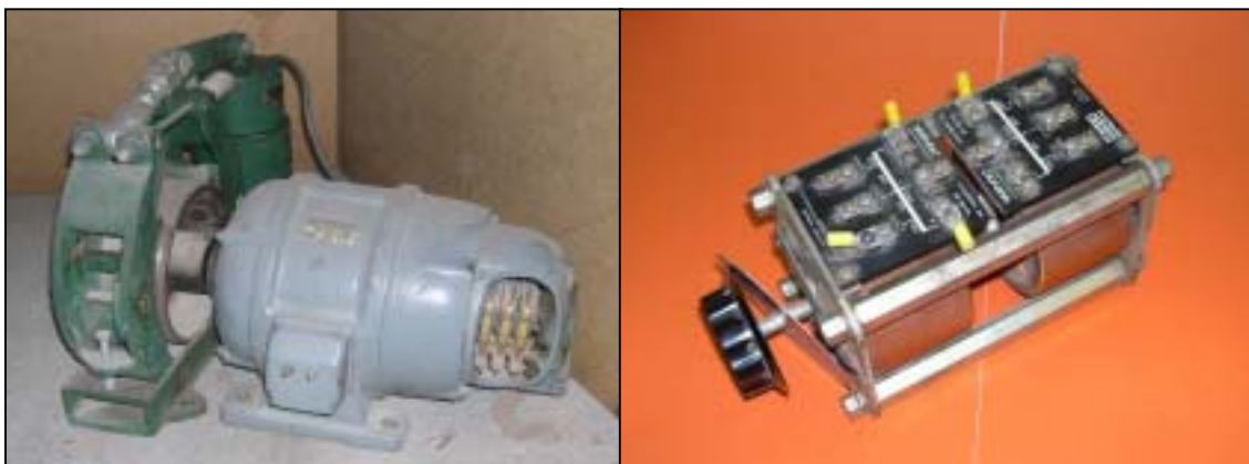
Máquina de la antigua central -- Variador de tensión "Varivolt"
