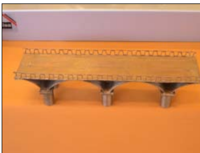
Ejercicio de soldadura de estaño realizado con hilo rígido
