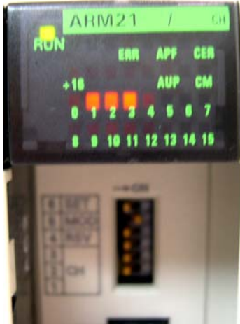
Ejemplo de instalación de tres esclavos AS-i con la asignación de direcciones 1, 2 y 3.
