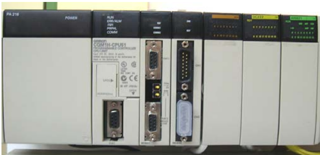
Disposición de módulos en el PLC CQM1H + ARM21 (AS-i)
