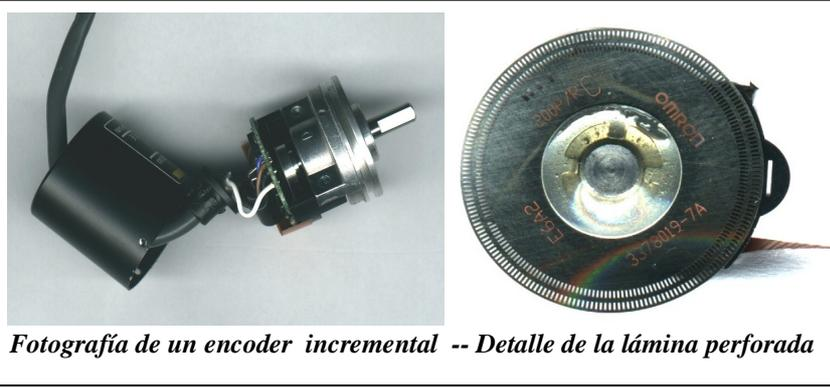
*Fotografía de un encoder incremental -- Detalle de la lámina perforada*
