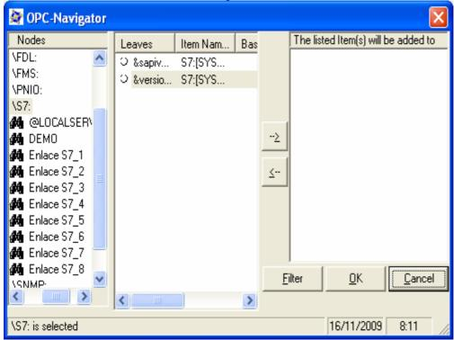
Seleccionar el enlace con el PLC deseado Por ejemplo con "Enlace S7-5". Seleccionar en "Objetos" la zona de memoria correspondiente al enlace, por ejemplo Q para las salidas.
