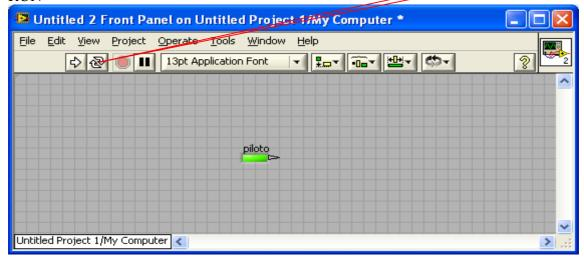
Si el funcionamiento es correcto, el triángulo de la derecha del piloto se pondrá en verde y éste cambiará de color en función de su estado (ON/OFF).
