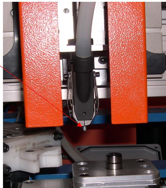
Ajustando el regulador de par se ha conseguido que el programa del PLC avance un par de etapas en el graficet de forma que después del primer atornillado saque tornillo a la boquilla y entonces se detenga indicando el error 8 (No vuelta pistones). Pulsando el botón de reset, desaparece el error y el atornillador queda en condiciones iniciales.
