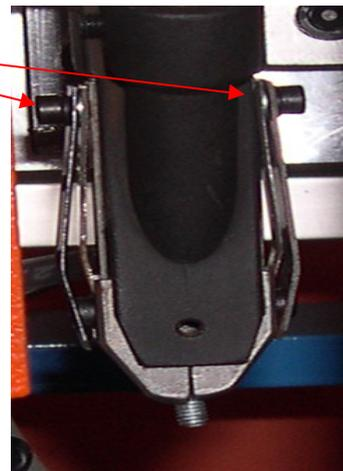
El alimentador de tornillos a veces se atasca cuando llega un tornillo en posición vertical, ~~quedando~~ el vibrador funcionando de forma continua. Retirar el tornillo atascado.
