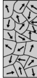
Si sobre un material ferromagnético no actúa ningún campo magnético externo, la orientación de los campos magnéticos de los dominios está ordenada al azar, como en la figura, pero si se aplica un campo magnético externo (como por ejemplo ocurre en los electroimanes), los campos magnéticos de estos dominios se orientan progresivamente en la dirección del campo magnético aplicado.
